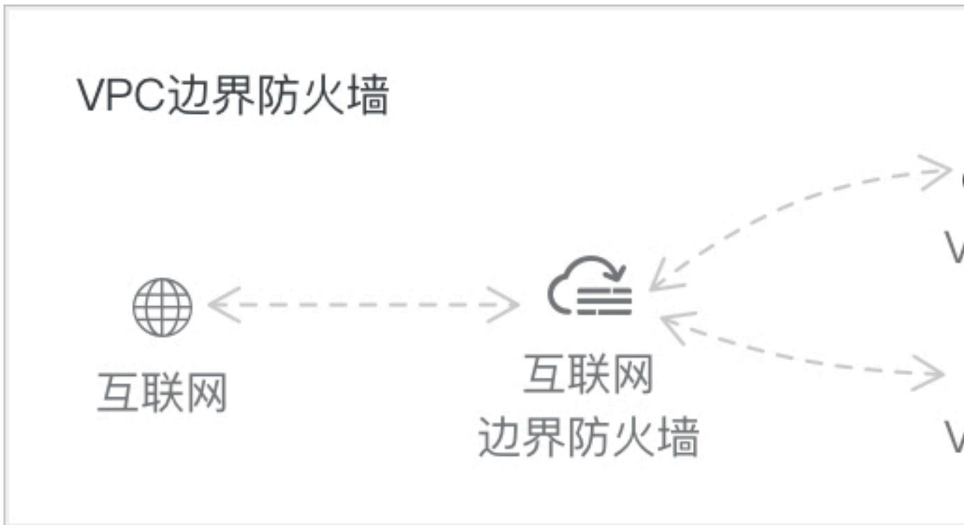
VPC边界防火墙仅支持部署在有高速通道联通的两个VPC间，或加入到同一个云企业网的两个VPC间。VPC边界防火墙不会默认存在，需要用户指定两个VPC进行创建。
