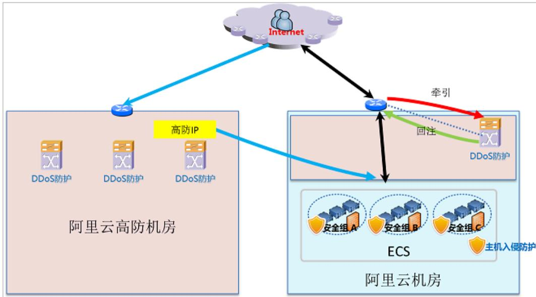
左侧是DDoS高防IP防护服务结构，右侧是阿里云提供的DDoS基础防护服务结构。
