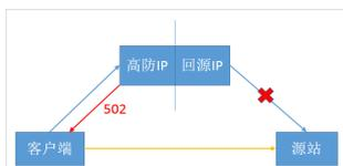
所以，在配置完转发规则后，强烈建议关闭源站上的防火墙和其他任何安全类的软件（如安全狗等），确保高防的回源IP不受源站本身安全策略的影响。同时，建议您参考[高防源站保护](#)通过安全组或白名单功能为您的源站配置保护措施。
