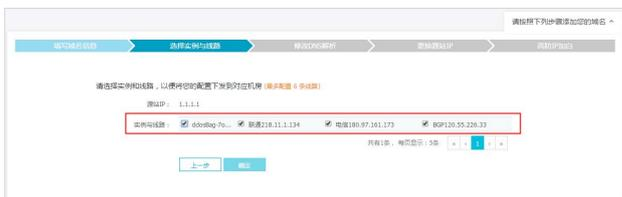
如图所示，可将需要防护网站的域名转发规则绑定到电信、联通、BGP三条线路。
