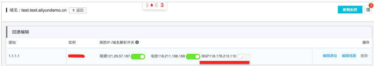
取消某条线路的解析后，网站流量将不再从某条线路进入。
