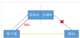
所以，在配置完转发规则后，我们强烈建议关闭源站上的防火墙和其他任何安全类的软件（如安全狗等），确保高防的回源IP不受源站安全策略的影响。
