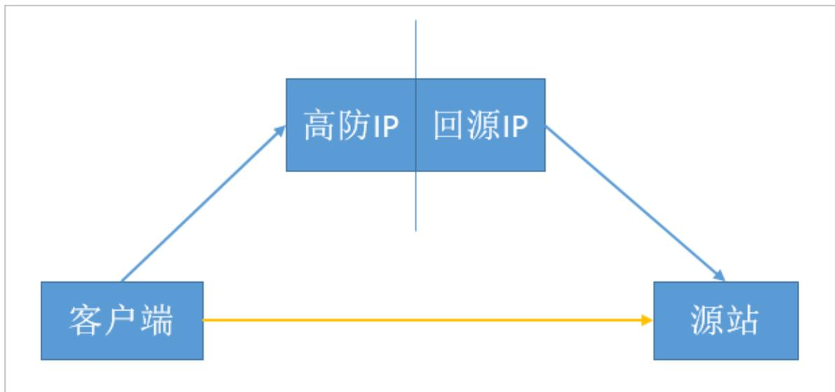
正常情况下，客户端请求访问高防IP，高防IP服务收到请求后把真实客户端的源IP转换成高防的回源IP（把真实客户端IP放在HTTP头部的X-Forwarded-For字段中）发送给源站。但是，如果源站IP暴露，客户端可以直接请求访问源站，这样就绕过了高防IP服务提供的防护。
