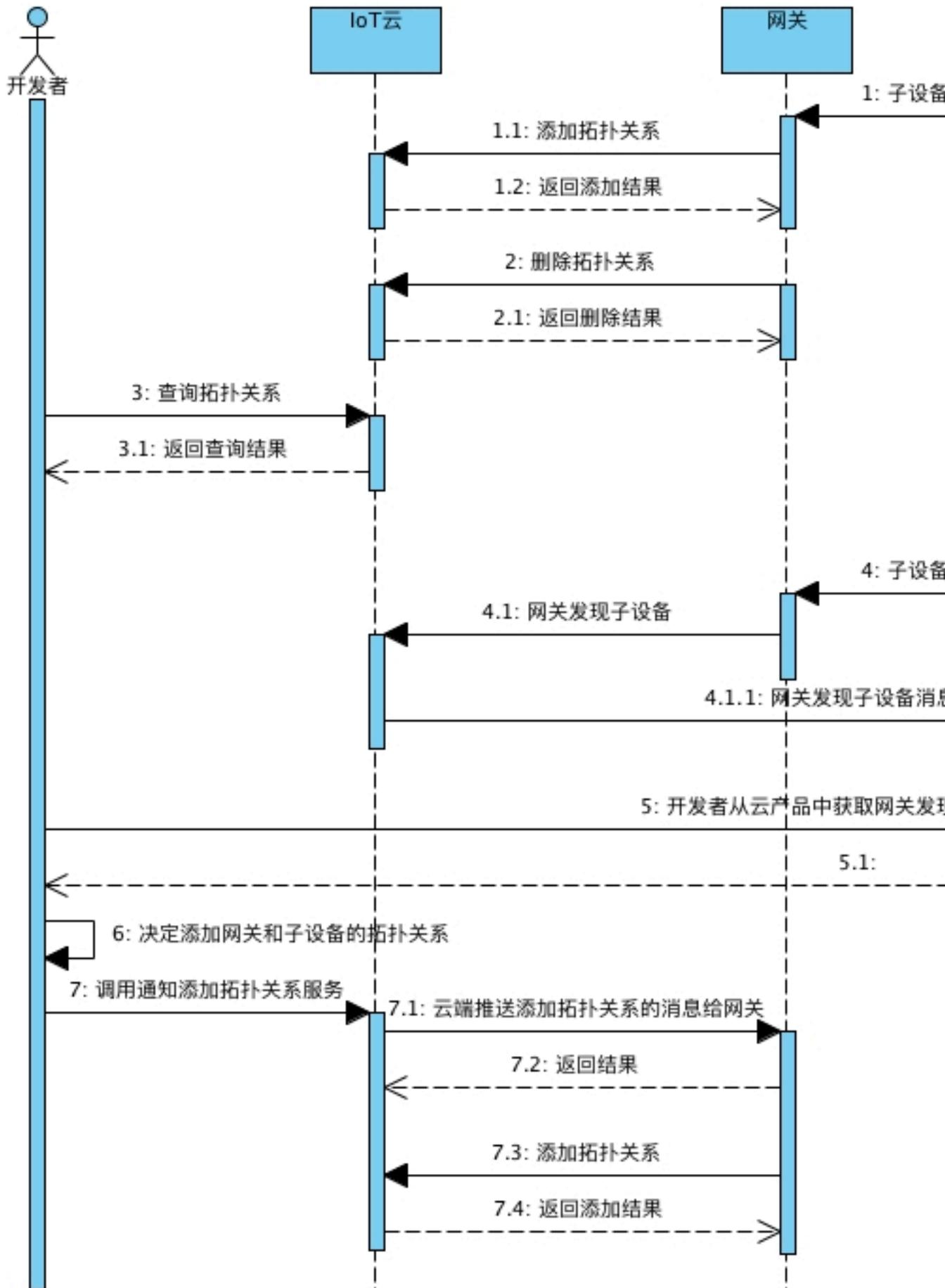
1. 子设备连接到网关后，网关通过添加拓扑关系Topic，添加拓扑关系，物联网平台返回添加的结果。
