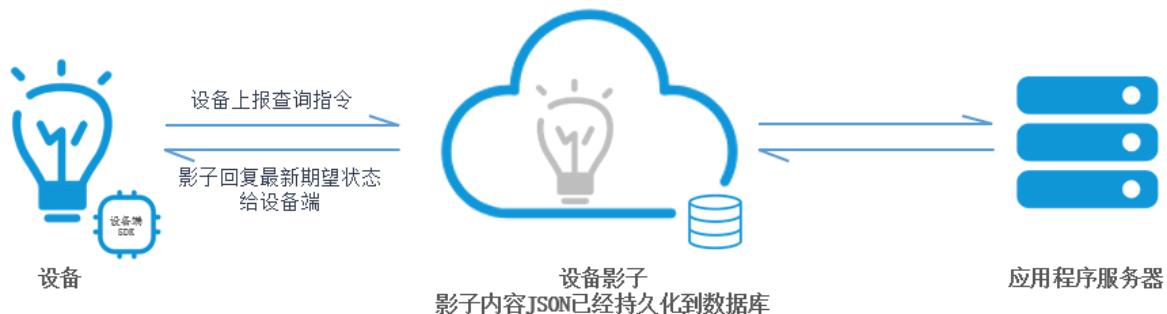
1. 灯泡主动发送以下消息到Topic/shadow/update/a1PbRCFQWfX/lightbulb中，获取设备影子中保存的最新状态。
