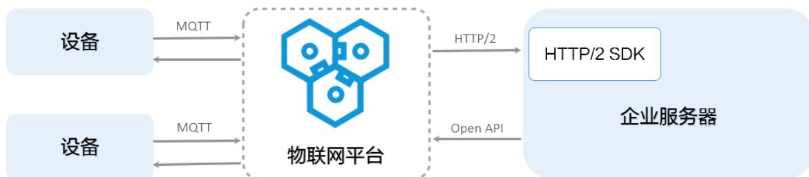
通过接入HTTP/2 SDK，企业服务器可以直接从物联网平台接收消息。HTTP/2 SDK提供身份认证、Topic订阅、消息发送和消息接收能力，并支持设备接入和云端接入能力。
