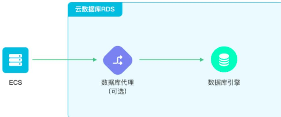
数据库代理位于运行于ECS的应用程序和数据库引擎中间，由RDS系统自动进行维护，所有的数据库请求和响应均从代理层经过并处理。
