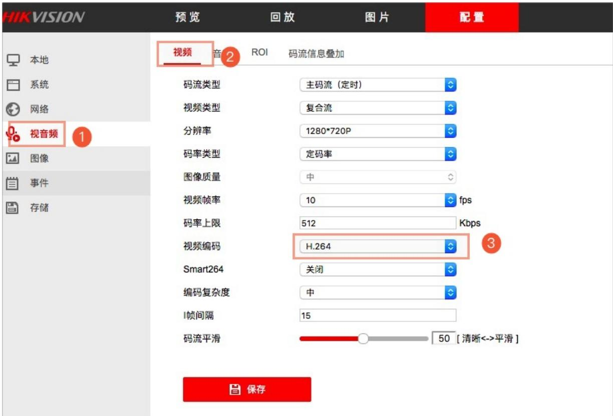
**说明** 如果使用RTMP推流方式，您的播放终端可以解码播放H.265视频，可以全程使用H.265编码进行接入、录制和播放，只不过在控制台不能实时预览和回看。国标目前不支持H.265编码监控流接入，计划将在12月支持。
