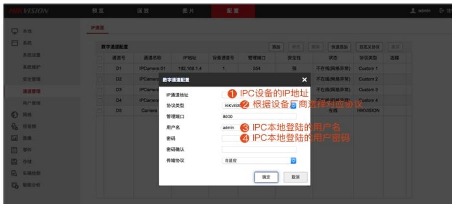
5. 在NVR上配置设备通道，为IPC配置通道编码后，通过获取NVR的通道编码找到对应的IPC设备。
