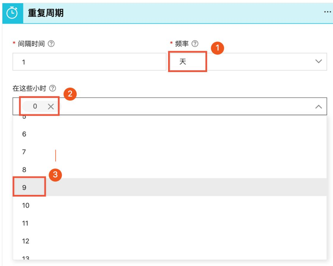
4. 在图形化设计的工具栏上，单击保存按钮，保存 workflow。此时我们已经创建了一个含有重复周期触发器的工作流。但该工作流在每天早上9点被触发后，没有执行任何操作。因此，接下来我们需要添加检查域名是否可用等操作。
