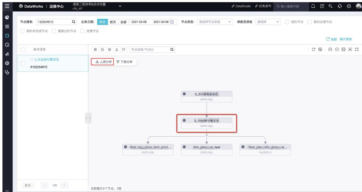
分析结果得出，导致阻塞当前节点运行的上游节点任务为数据表同步及指标统计，如下图所示。通过该分析结果，您可以快速定位阻塞节点，并及时处理相关报错。
