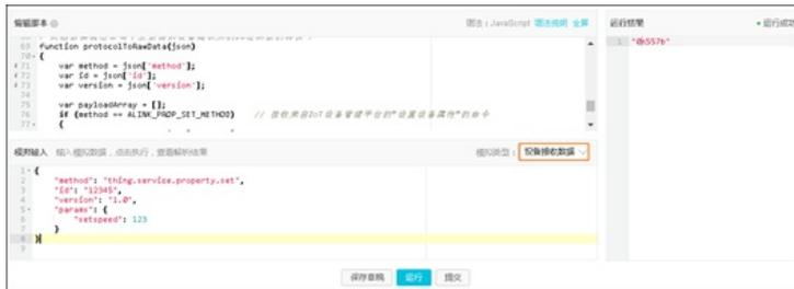
4. 确认脚本可用后，单击提交按钮，将脚本提交到物联网平台。
