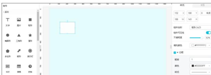
iii. 拖拽一个文字组件，重叠于矩形组件上，然后单击右侧配置栏中的数据，配置文字组件的数据源为气象监测设备的温度属性。设置完成后，该文字组件将显示气象监测设备上报的温度值。
