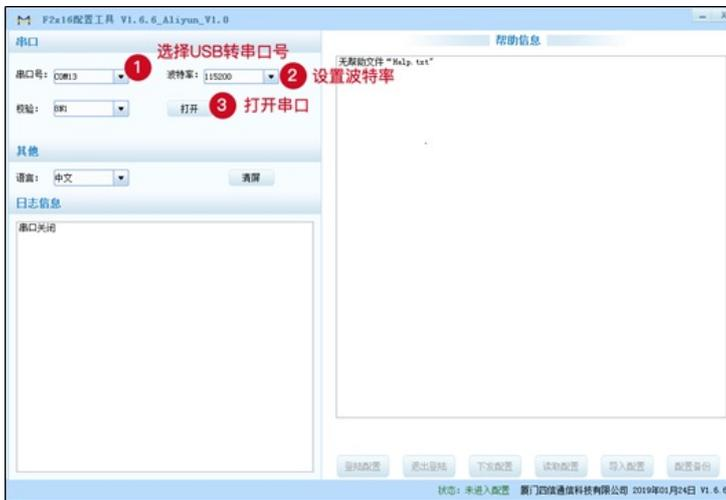
iii. 单击右下方登陆配置按钮，使DTU进入配置状态。
