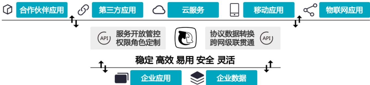
如下图所示，开放平台可以把企业内外应用所提供的服务发布成API，供消费方订阅调用，并提供审批授权、服务管控和计量监控等能力。开放平台不仅仅是把内部服务开放到外部，如图中标号为①到④所示，还可以是内到内、内到外、外到内、外到外各种方向的灵活开放方式。如其中②所示的开放方式，以及③和④的组合效果所示，一个服务可以同时开放成具有多个不同协议入口、甚至是不同开放方向的API。
