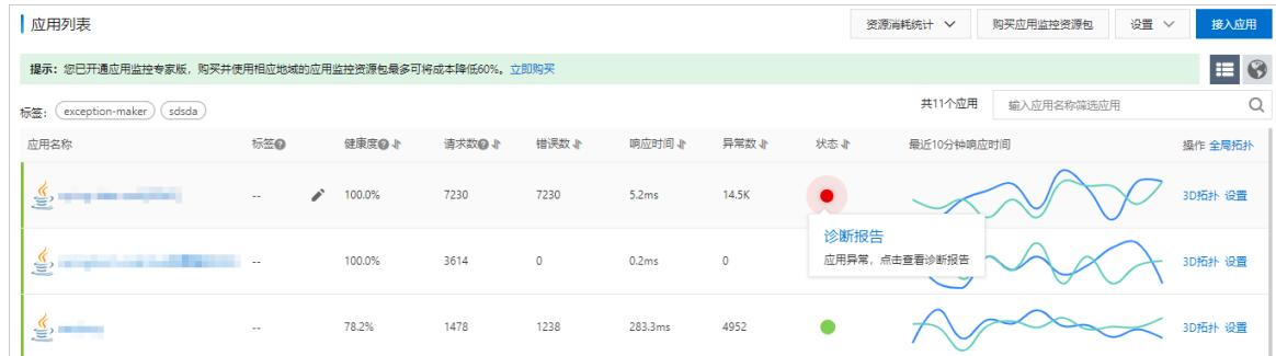
也可以在应用列表页面单击目标应用名称，进入应用总览页面，将鼠标悬浮于应用健康概览右侧的!图标，出现检查到异常，单击查看详情的提示，单击!图标，加载诊断报告。加载完成后，再次单击!图标进入诊断报告页面。
