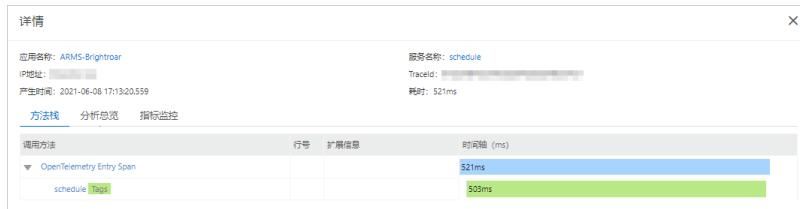
目前ARMS支持将OpenTelemetry Span的Attribute作为Tags展示，将鼠标悬浮于Span名称后面的Tags即可看到Span的Attribute。
