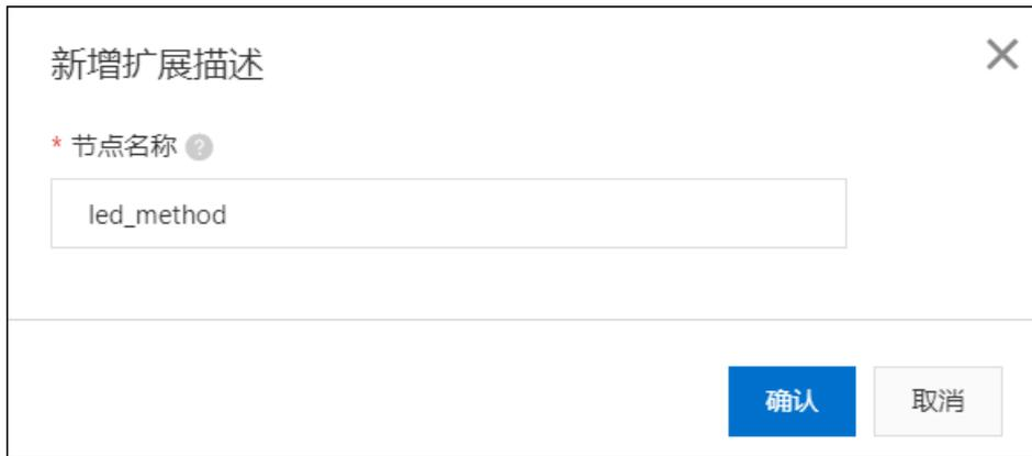
节点名称：设备method在OPC UA Server中的变量节点DisplayName的值。
