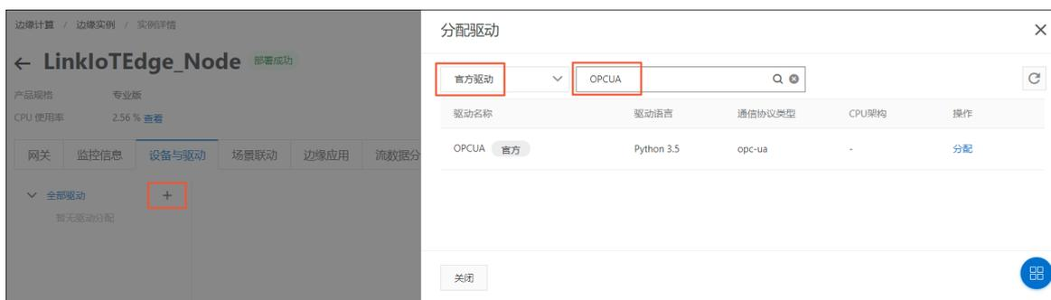
4. 选择OPCUA驱动，单击设备列表后的驱动配置，在弹出对话框中单击添加通道，设置通道参数。
