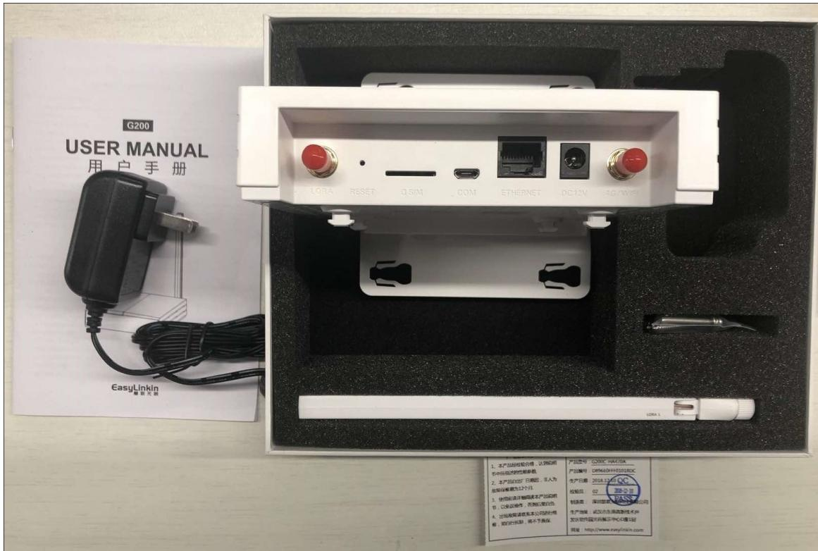
2. 插上网线与电源，登录**物联网网络管理平台**控制台注册网关。
